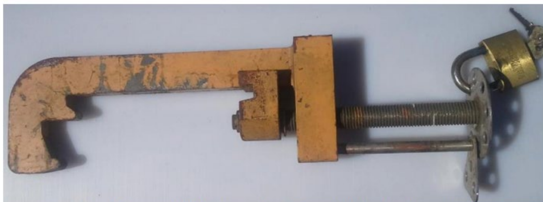
Type 1 "Gammel 1975" (bøjlen ca. 34 cm lang, med klods der glider på jernet)
